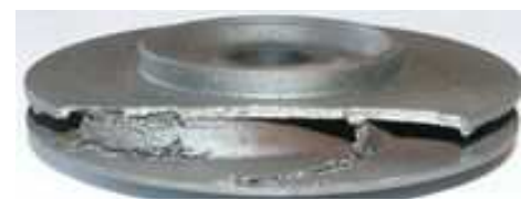
Figura 4.3. Danni provocati dalla cavitazione alla girante di una pompa [Wikipedia]
