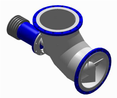
Figura 3.1. Rappresentazione schematica di una pompa ad elica ad asse orizzontale
